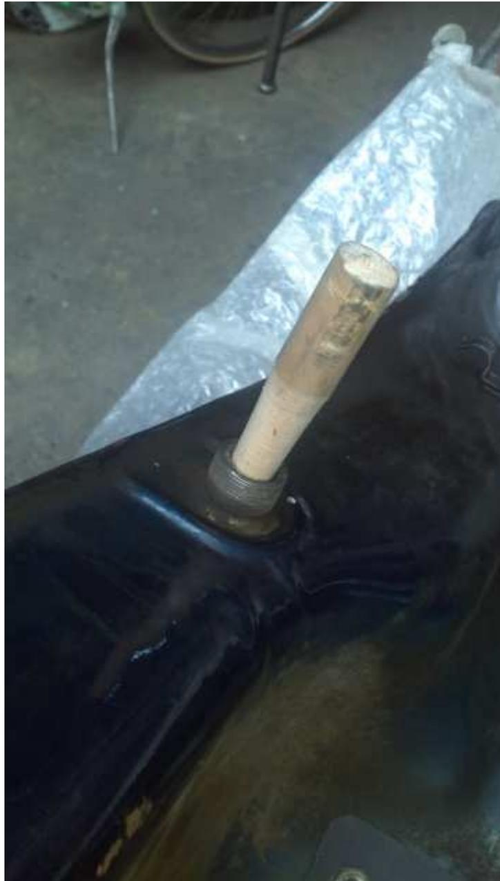
Ora occorre rimuovere il tappo a chiave e costruirsi un tappo posticcio. Tenete presente che il foro di immissione si prolunga verso l'interno del serbatoio con un bocchettone alto 25/30mm, io l'ho realizzato con un tappo in sughero da damigiana, l'esterno dovrà avere un diametro di 40mm, alto 30/40mm, anche questo dovrà avere una certa conicità così da andare a bloccarsi una volta inserito.
